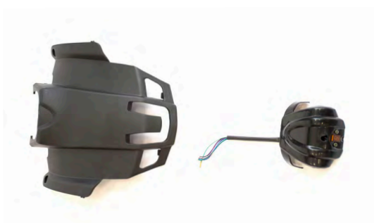
Облицовка передняя верхняя (код 14); накладка руля с индикатором включенной передачи (код 15)
