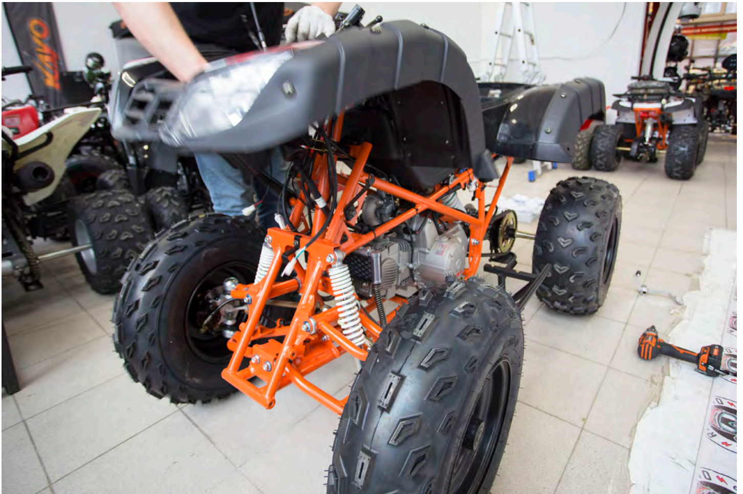
Протягивание элементов проводки, гидролинии тормозов и тросиков привода карбюратора через технологические отверстия.
