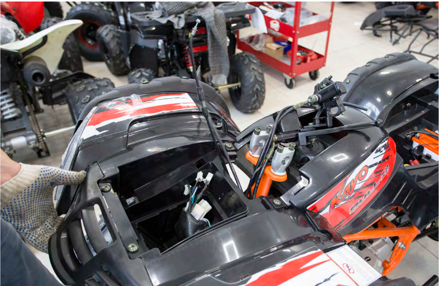
Протягивание элементов проводки, гидролинии тормозов и тросиков привода карбюратора через технологические отверстия.
