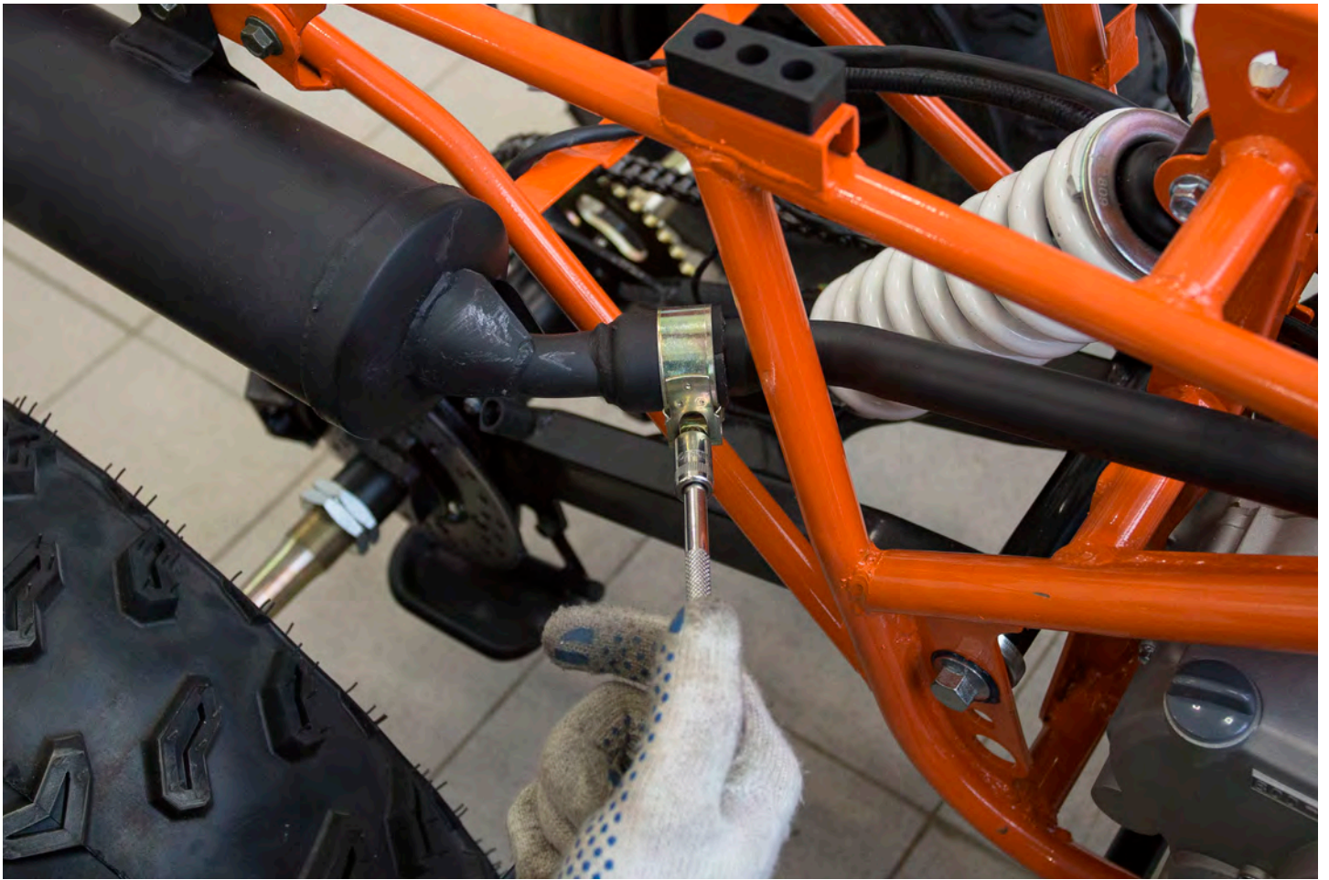
Крепление глушителя к раме, болт (код 42).
