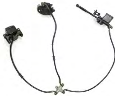
Тормозная система передняя (код 100)
