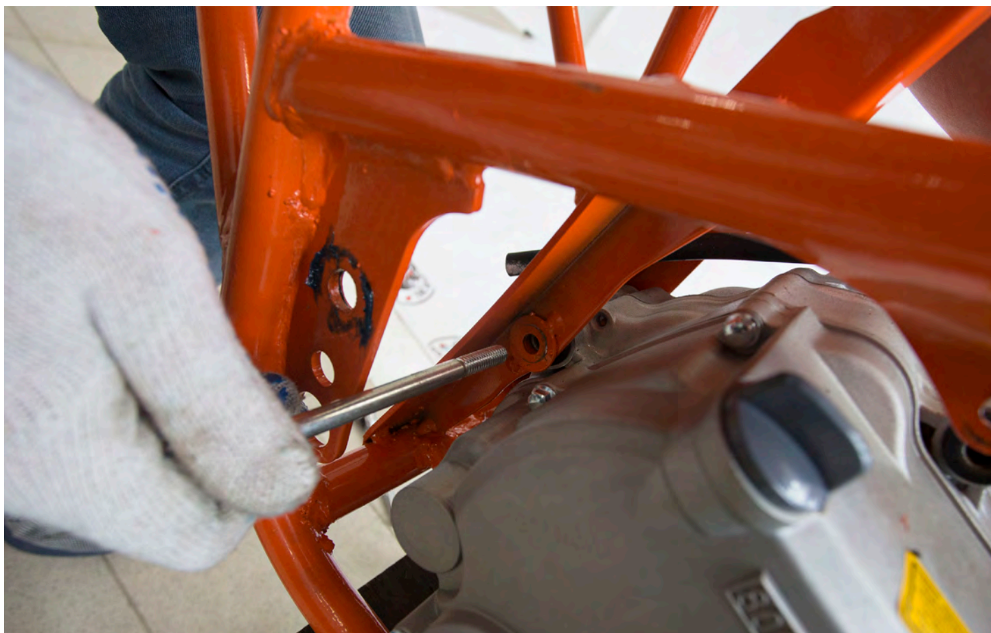
Заднее крепление двигателя. Болт (124) + гайка (125)
