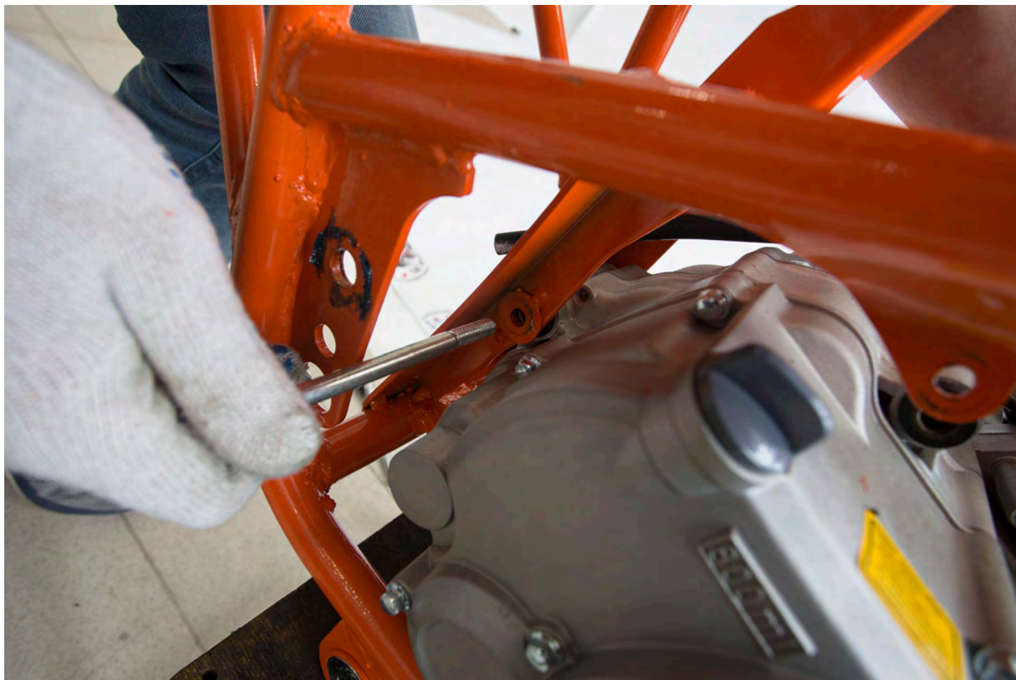
Заднее крепление двигателя. Болт (124) + гайка (125)
