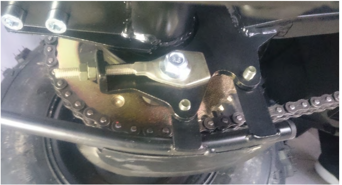
Установка заднего амортизатора, болты (код 97) = 2шт + гайки (код 93) = 2шт.
