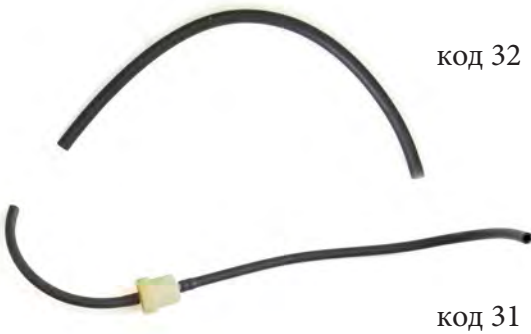
Вентиляционный шланг крышки бензобака (код 32). Топливный фильтр и шланги топливной магистрали (код 31)
