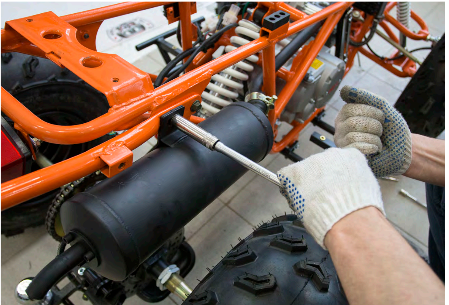
Крепление глушителя к раме, болт (код 42).
