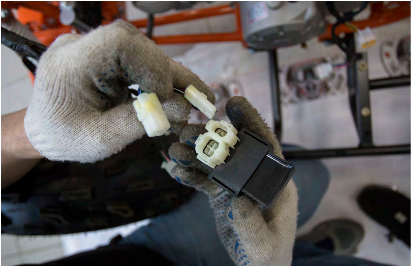
Соединение разъемов коммутатора CDI с разъемом жгута проводки (код 46).
