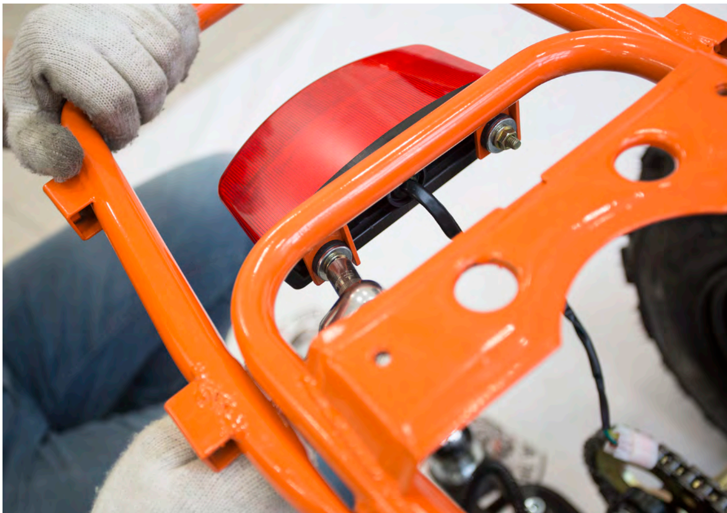
Протягивание жгута проводки внутри рамы (код 46).
