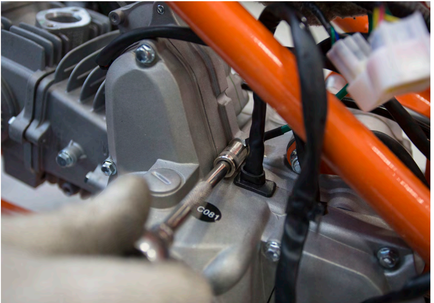
Соединение разъемов коммутатора CDI с разъемом жгута проводки (код 46).
