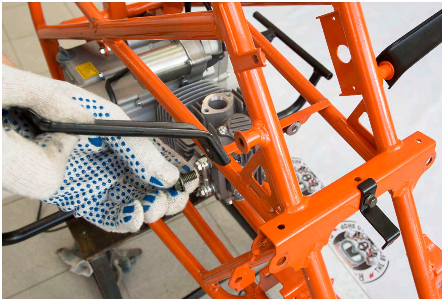
Крепления пластика боковые (115) + болты (129)
